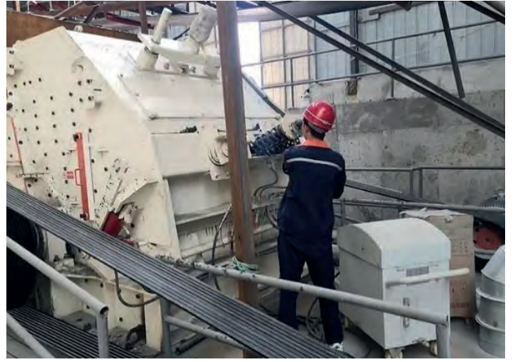
Görsel 21 Bir İkincil Kırıcı Örneği (Impact Crusher) Darbe Tipi [34]
