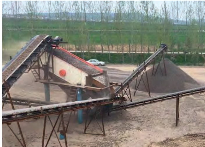
Görsel 23 Mobil Eleme Ünitesi (Titreşimli Elek)
