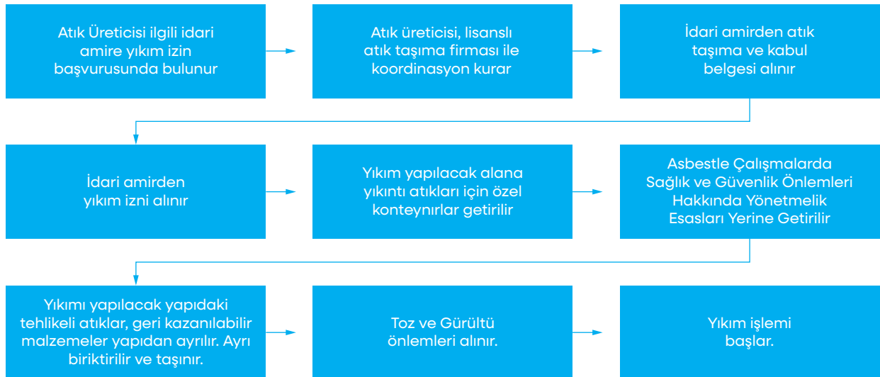
Şekil 26 Kentsel Dönüşüm ve Diğer Yıkım İçeren İşlerde Yıkıntı Atıkları Oluşması Süreci
