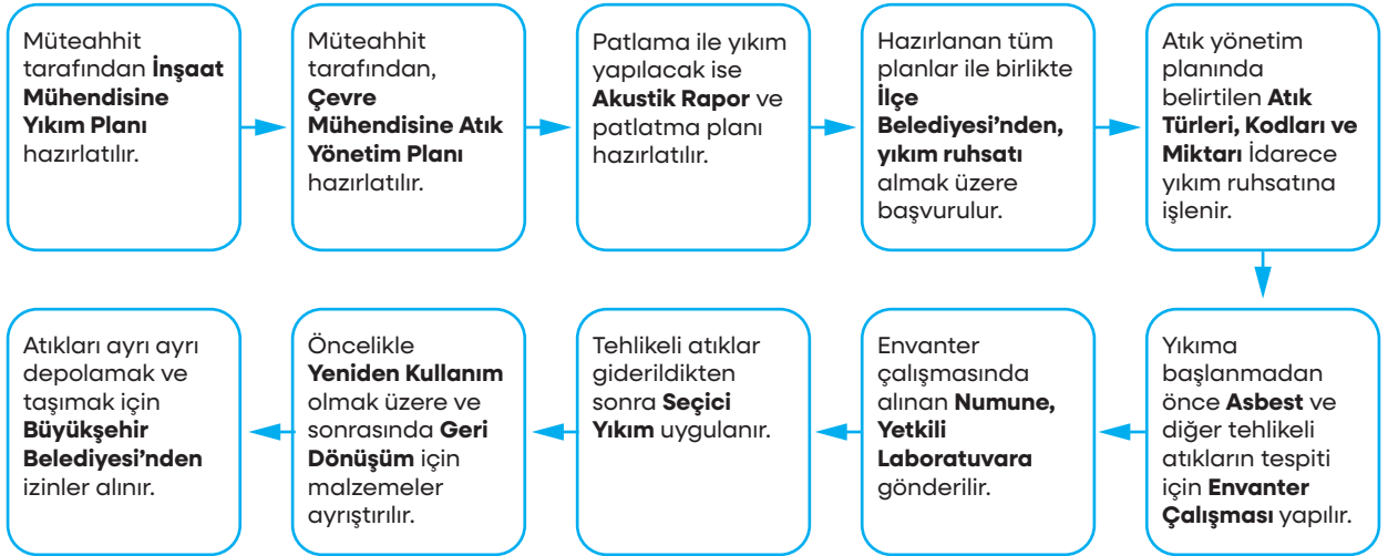
Şekil 25 Kentsel Dönüşümde Bina Yıkım Süreci
